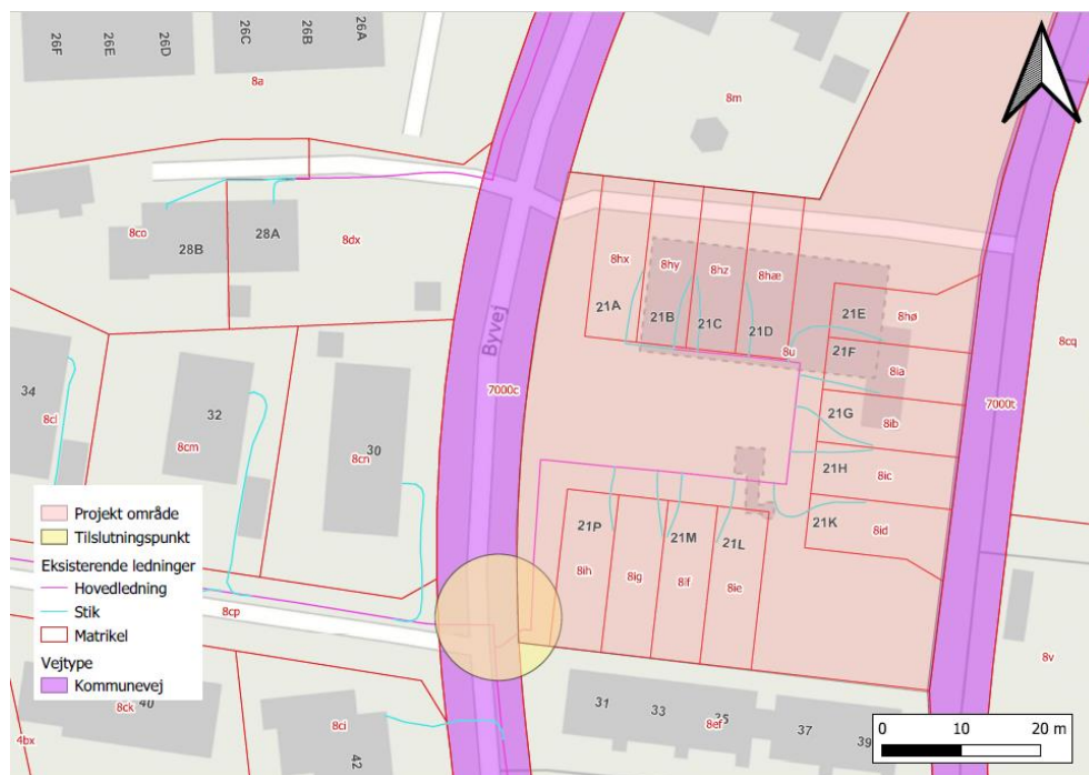
Figur 5.3 Placering af tilslutningspunkt på hovedledning.
